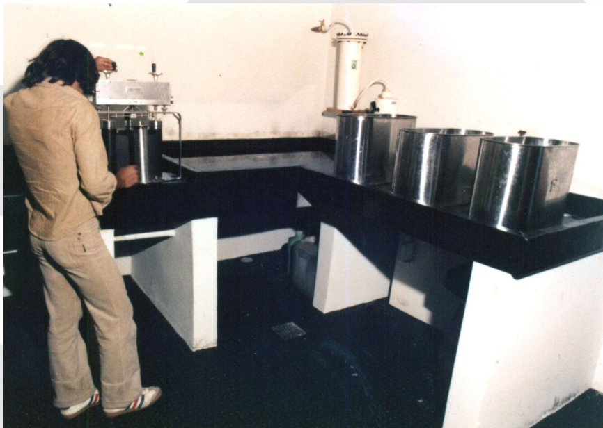
Reveladora de Filme Aéreo e cubas de processamento
