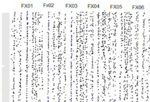
Pontos de ligação de imagens para um bloco utilizando câmara digital
