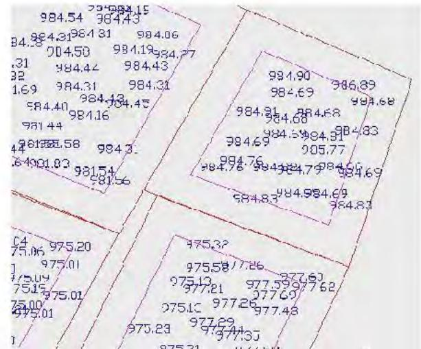
FIG. 6 - Pontos do MDS considerados na determinação da altura da edificação
