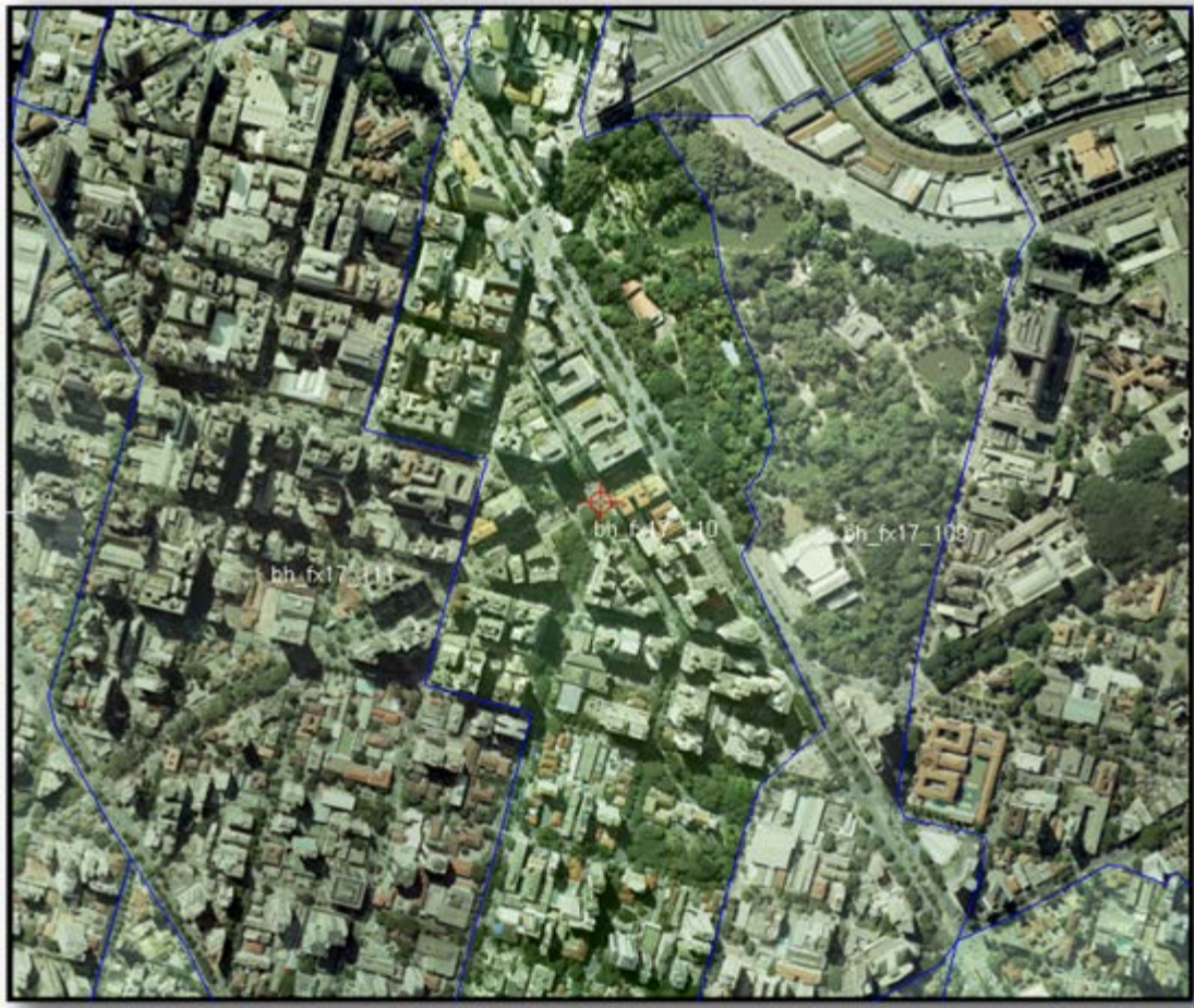
Figura 01_ Exemplo de quantidade de emendas na mosaicação de uma ortofoto e das diferenças radiométricas entre as fotos.
