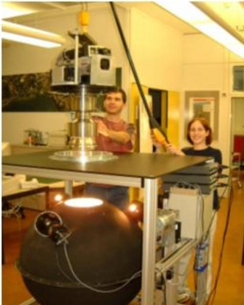
Esfera para calibração Radiométrica. Fonte:LEICA
