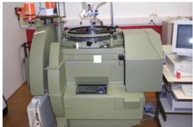
Goniômetro para calibração Geométrica. Fonte:LEICA
