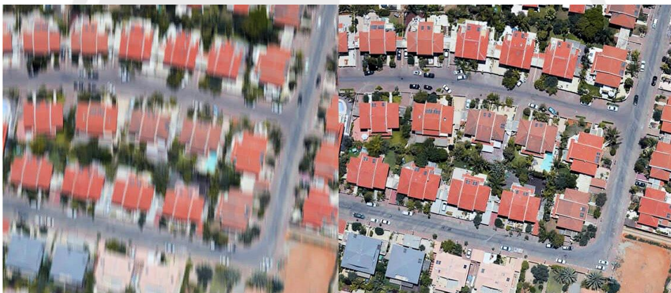
Imagem aérea coletada sem e com a utilização do FMC, em condições adversas. ( https://industrial.phaseone.com/PhaseOne-FMC )
