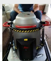
Plataforma Leica PAV100 e o uso com diferentes Sensores
