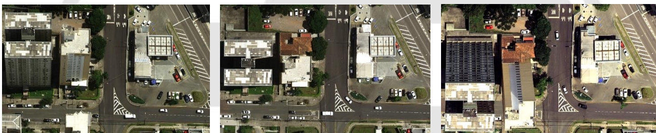
Imagens RGB – Visadas Anterior (19°), Nadiral (0°) e Posterior (26°) – Oriundas de uma das primeiras faixas de voo com sensor ADS100 – Curitiba
