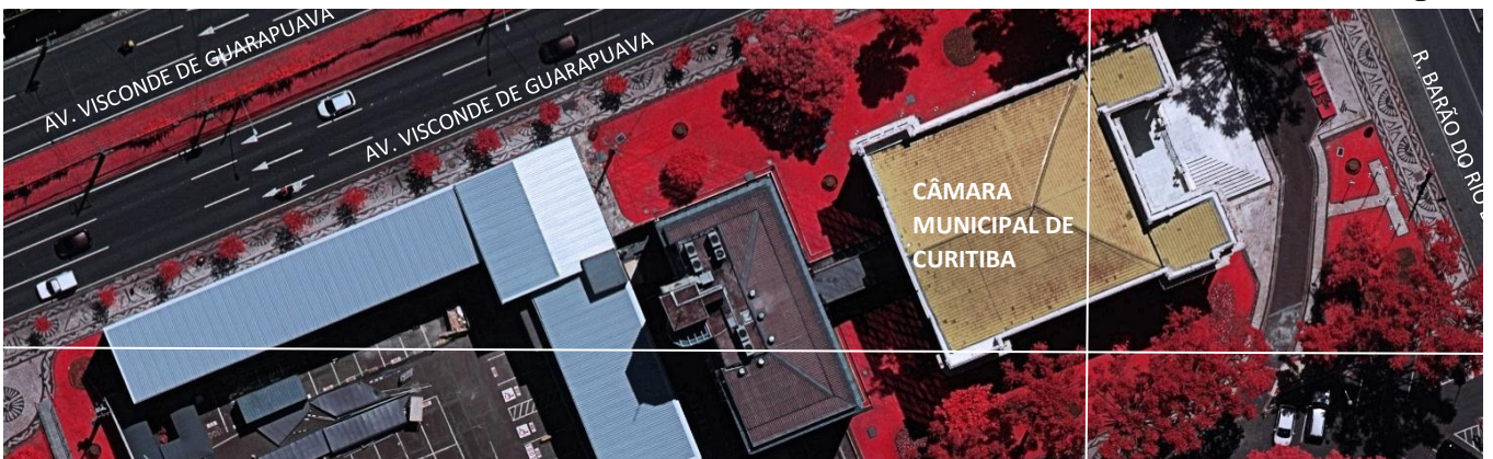
Parte de uma Semi-true Ortofotocarta de Curitiba – Imagem infravermelha obtida com sensor linear Leica ADS100 – GSD 4cm
