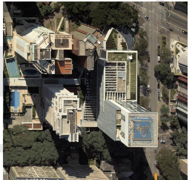
Imagem aérea com o deslocamento da imagem provocado pela projeção cônica do sistema de lentes da câmara aérea
