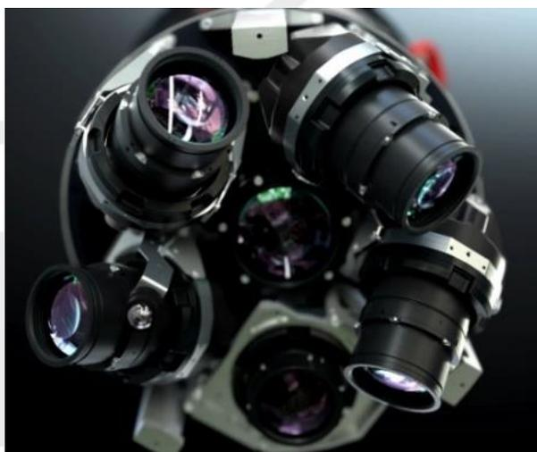
como para mapeamento de grandes áreas, pois sua altura máxima de operação é de 5.500 metros, sendo possível também ajustar o ângulo de abertura do laser e eventualmente trocar a distância focal da câmara nadiral permitindo diferentes alternativas do campo de visão – o que caracteriza a grande versatilidade de utilização desse sensor.
