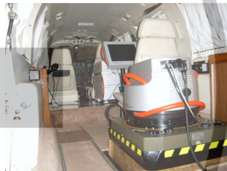
Câmara Aérea ADS-40 instalada na Aeronave
