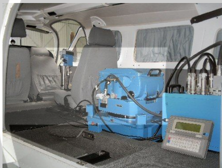
Câmara Aérea RMK-TOP instalada na Aeronave
