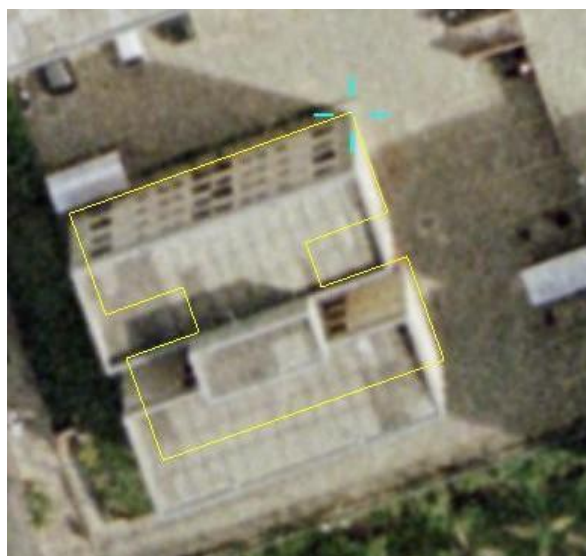
Figura 1. Edifício com deslocamento (do topo) na imagem, sobreposto por vetor oriundo de restituição fotogramétrica.
