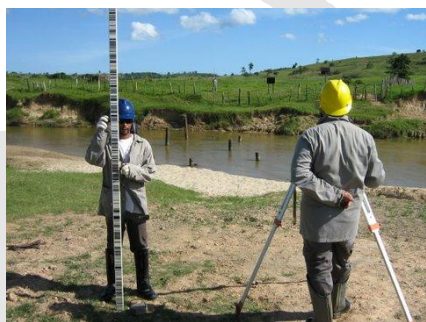
Estudo de travessias – equipe de nivelamento
