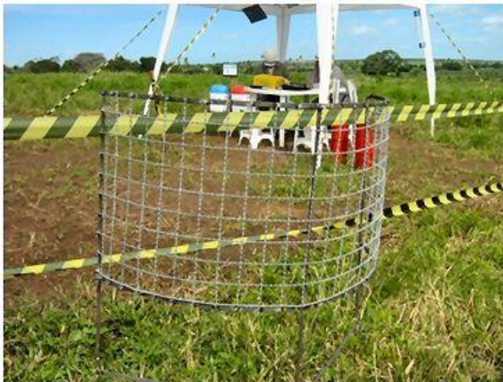
EPC - grade protetora para o eixo de rotação, sondagem rotativa.
